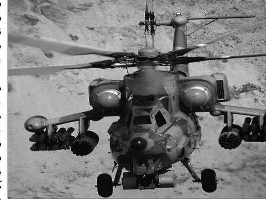
في الجزائر. وتتصف بدروعها القوية، مقصورة على تحمل إصابات مباشرة برصاصات من عيار 12,7 مم وقد اتلت من عيار 23 مم، كما أنها تنسق بقدرة فائقة على مكافحة الدبابات المعاكية ليل ونهاراً، وتوجد في "مي 28 آن" مروحتان أفقيتان أساسية وخلفية، وهي مجهزة بدرعه فولاذيه تستطيع مقاومة قذائف من عيار 23، تطير بسرعة قصوى تقدر بـ 300 كيلو متر في الساعة. كما يمكنها الطيران إلى الخلف
